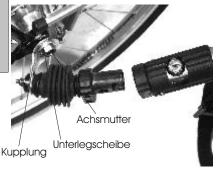
Zum Verbinden muß die Kupplung solgedreht werden, dass die abgeflachten Seiten von Trailer und Kupplung nach Außen stehen. Dann Trailer und Kupplung zusammen stecken und die drehbare Sicherung drehen, bis der Sicherungsknopf einrastet (siehe Abbildung).
